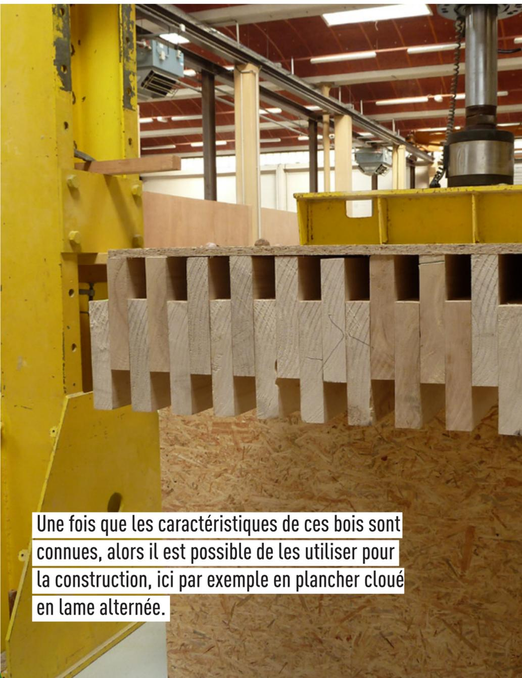
Une fois que les caractéristiques de ces bois sont connues, alors il est possible de les utiliser pour la construction, ici par exemple en plancher cloué en lame alternée.
