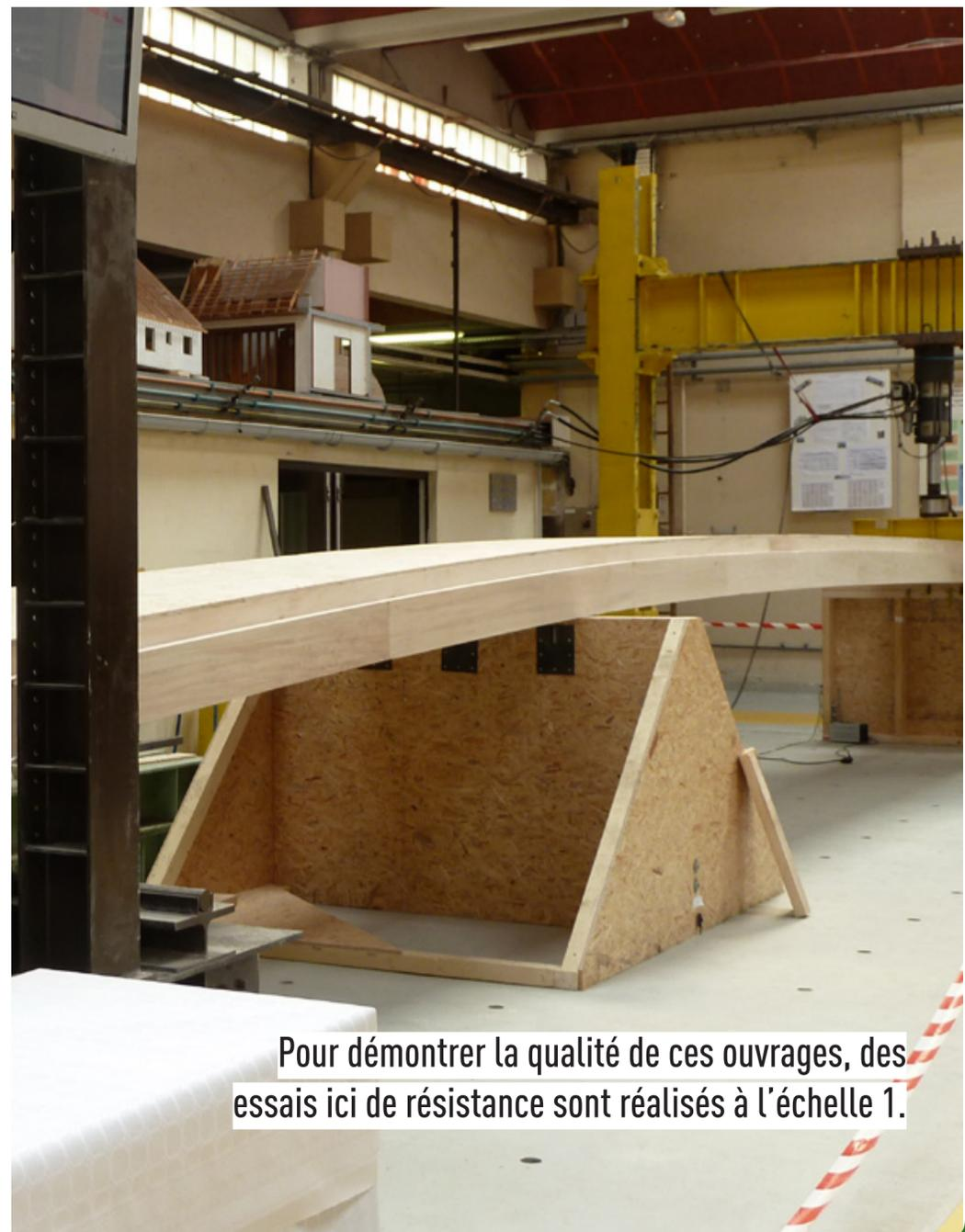
Pour démontrer la qualité de ces ouvrages, des essais ici de résistance sont réalisés à l'échelle 1.
